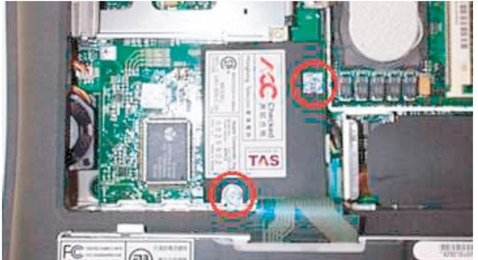
**[ 図 2 ]** モデムカードをはずすと、手前にあるキーボードのケーブル上にコネクタを抜くための取っ手状のフィルムがある。これを持って、丁寧にコネクタを引き上げる。（従来のものと違って、ロック機構がないので引き上げるだけではずれる。）
