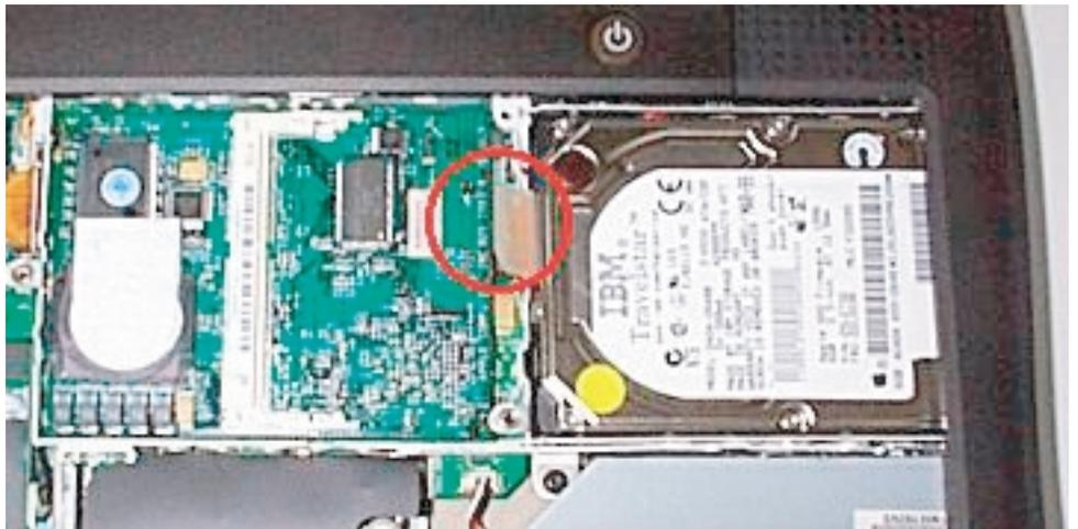
**[ 図 2 ]** ハードディスクドライブを引き上げた状態。円で示した部分がマザーボードとのコネクタ。注意深く抜くこと。
