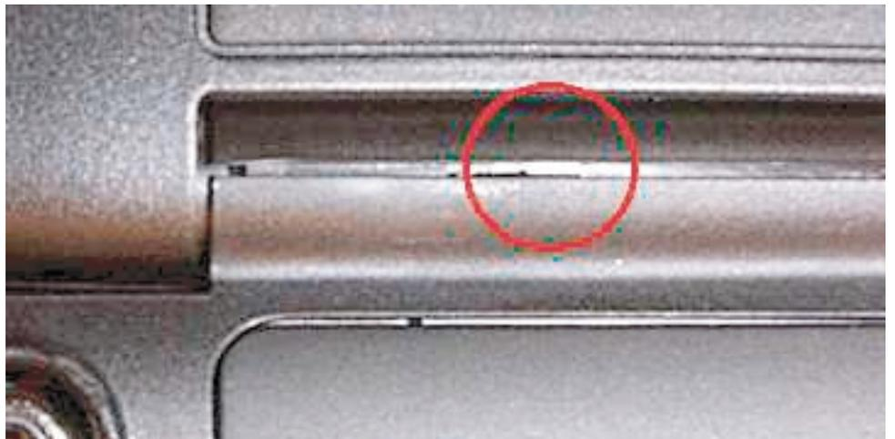
[ 図 2 ] ツメをはずした状態で、ディスプレイを広げ、うしろ側から持ち上げるようにしてははずす。
