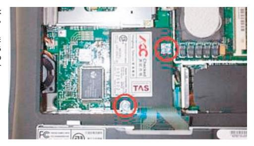
[図2]モデムカードをはずすと、 手前にあるキーボードのケーブル上 にコネクタを抜くための取っ手状の フィルムがある。これを持って、丁 寧にコネクタを引き上げる。(従来 のものと違って、ロック機構がない ので引き上げるだけではずれる。)
